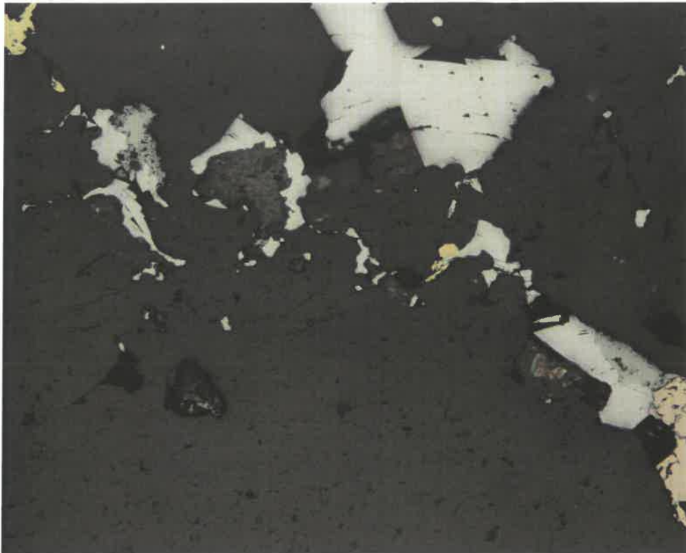
Obr. 63 Stefanit (světle šedý) zatlačující galenit (bílý), jenž obrůstá pyrrhotin (nahnědlý) a siderit (šedý) v křemeni (černý). Nábrus, PPL, šířka záběru 1.44 mm.
