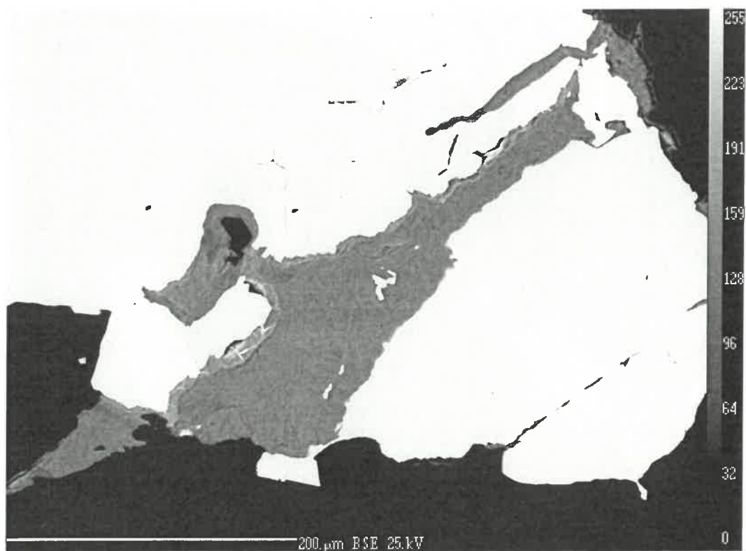
Obr. 15 Slabě zonální chlorit (šedý) žilkovitě pronikající křemenem (černý) a rudními minerály (sfalerit, chalkopyrit – bílé). Nábrus, obraz BSE.
