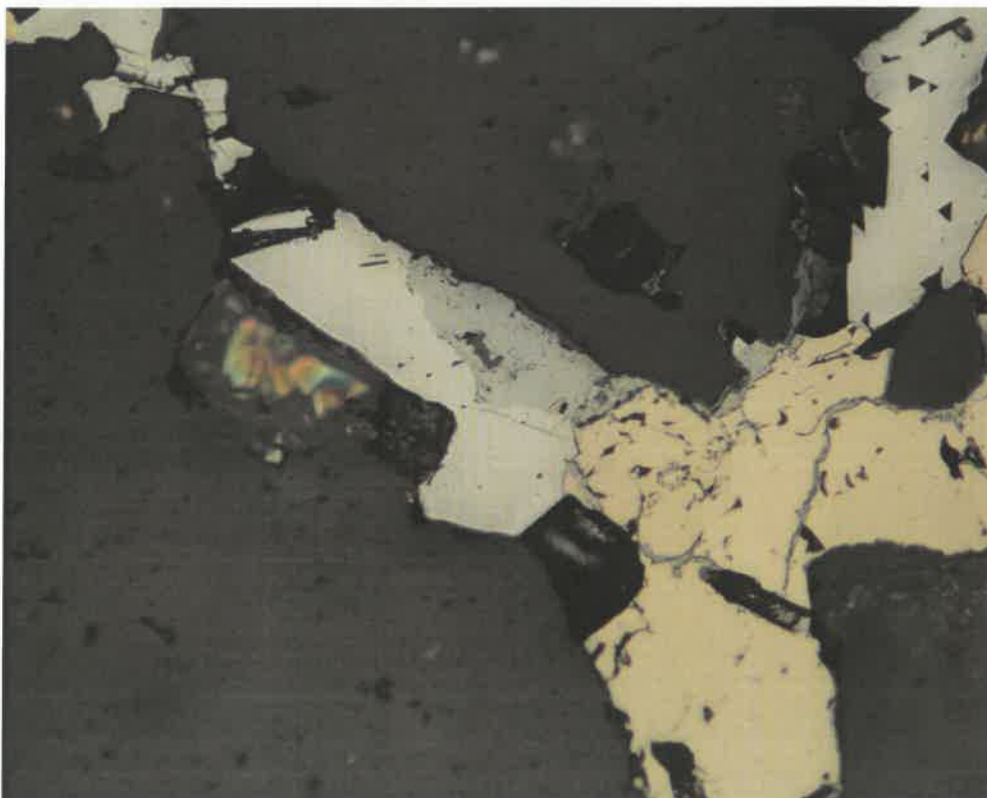
Obr. 64 Detail z obr. 63, stefanit (světle šedý) zatlačující galenit (bílý) v kontaktu s pyrrhotinem (nahnědlý) v křemeni (černý). Nábrus, PPL, šířka záběru 0.72 mm.
