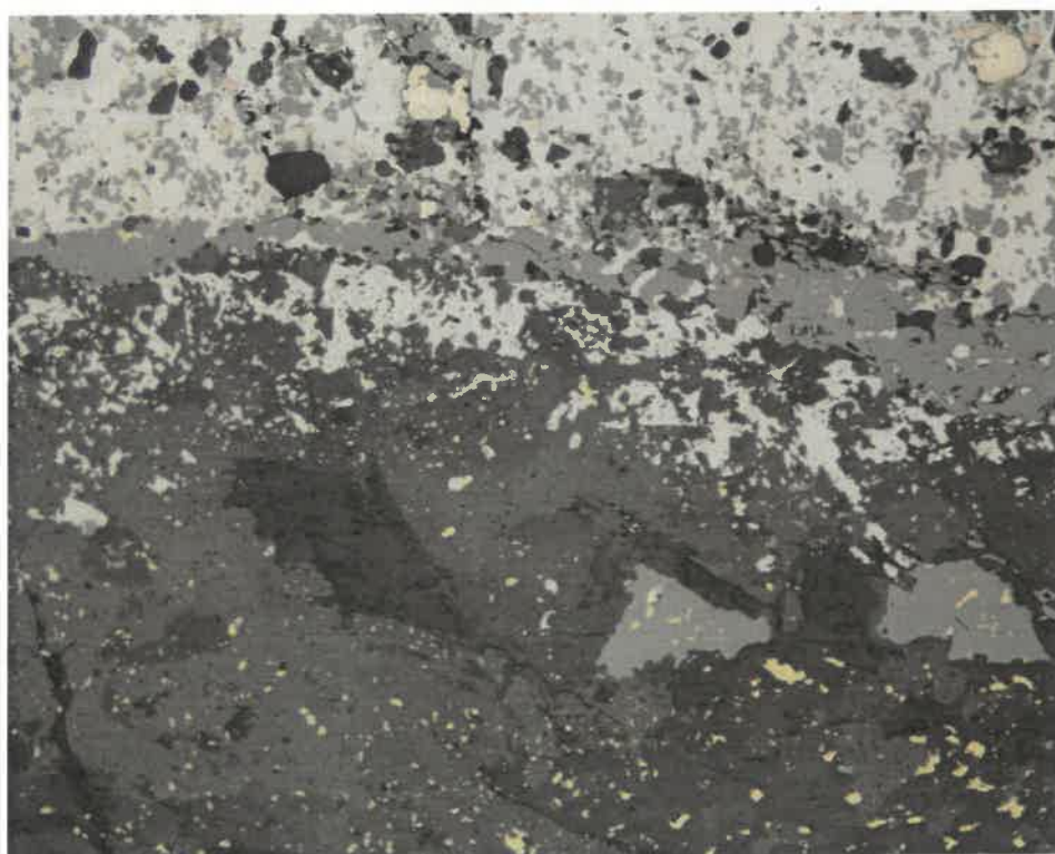
Obr. 4 Iniciální stádium zatlačování sideritu (nejtmavší) od okrajů zrn rudami (sfalerit – šedý, galenit – bělavý). Nábrus, PPL, šířka záběru 3.6 mm.
