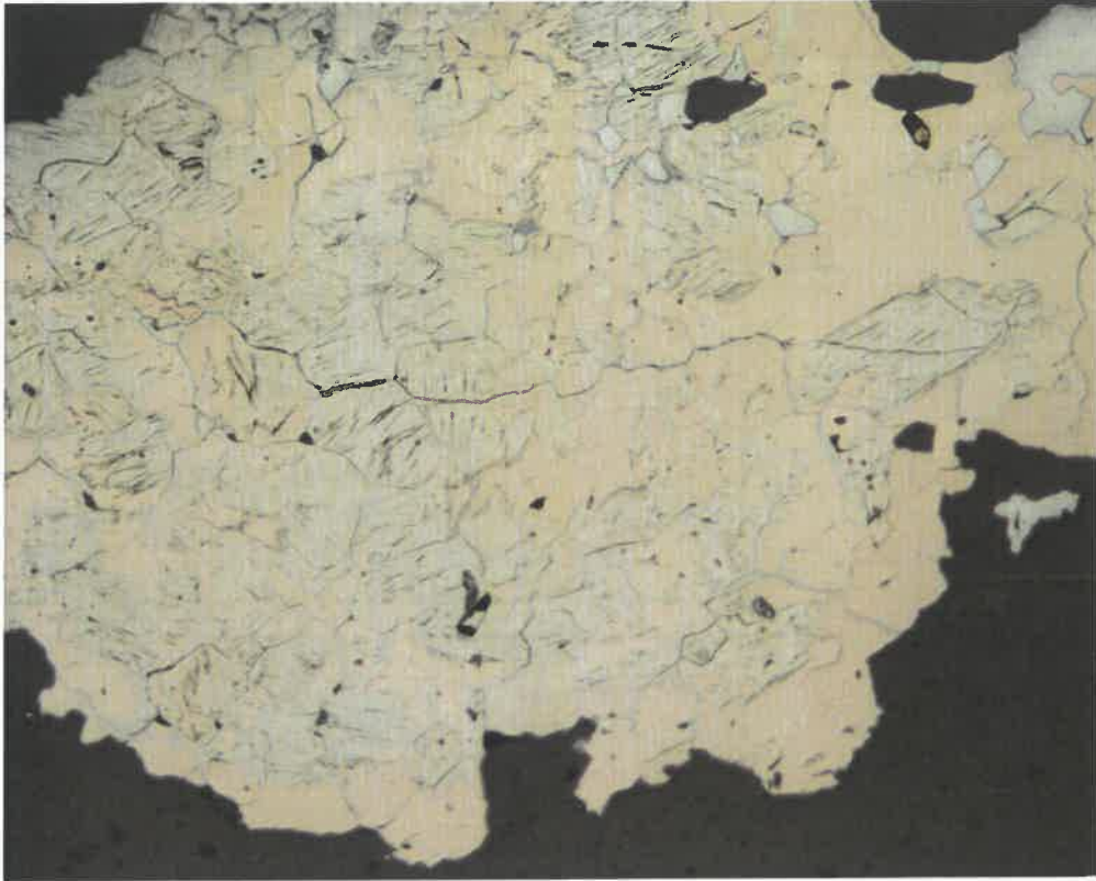
Obr. 33 Zatlačování pyrrhotinu (nahnědlý) směsí pyritu a markazitu (krémové). Bílý – galenit. Nábrus, PPL, šířka záběru 0.72 mm.
