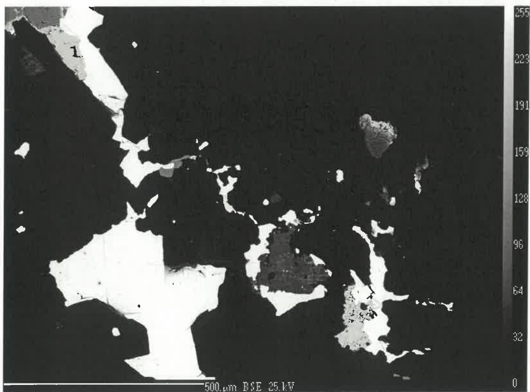
Obr. 66 Stefanit (světle šedý) zatlačující galenit (bílý), jenž obrůstá pyrhotin (středně šedý) a siderit (tmavě šedý) v křemenu (černý), oblast obr. 63. Nábrus, BSE obraz.
