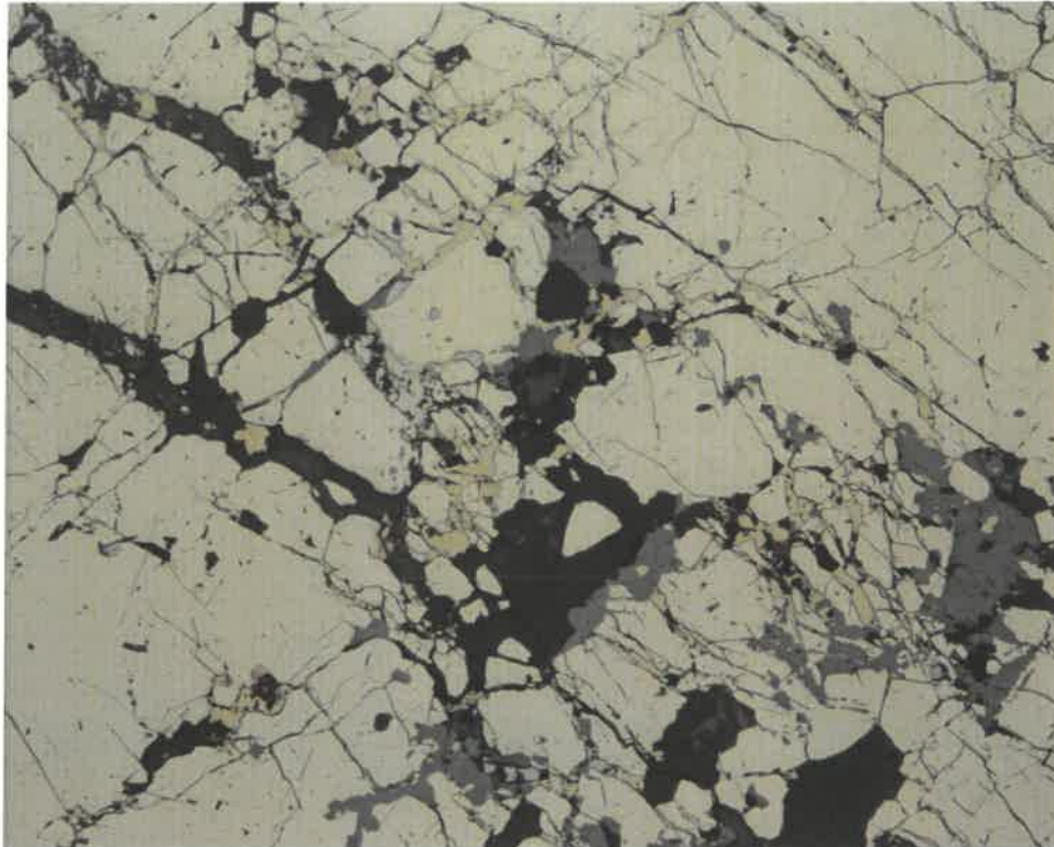
Obr. 23 Masivní pyrit (krémový) hojně pronikáný žilkami se sfaleritem (šedý), chalkopyritem (žlutý) a křemenem (černý). Nábrus, PPL, šířka záběru 1.44 mm.
