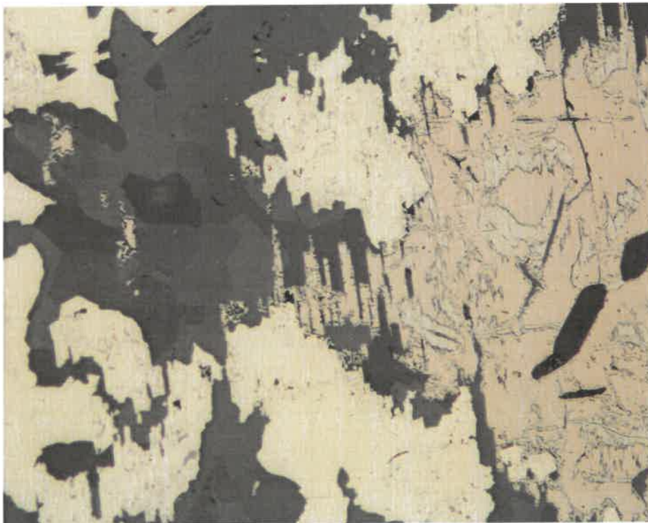
Obr. 8 Zatlačování pyrhotinu (nahnědlý) sideritem (tmavý se zřetelným dvojdrazem) a pyritem (krémový). Nábrus, PPL, šířka záběru 1.44 mm.
