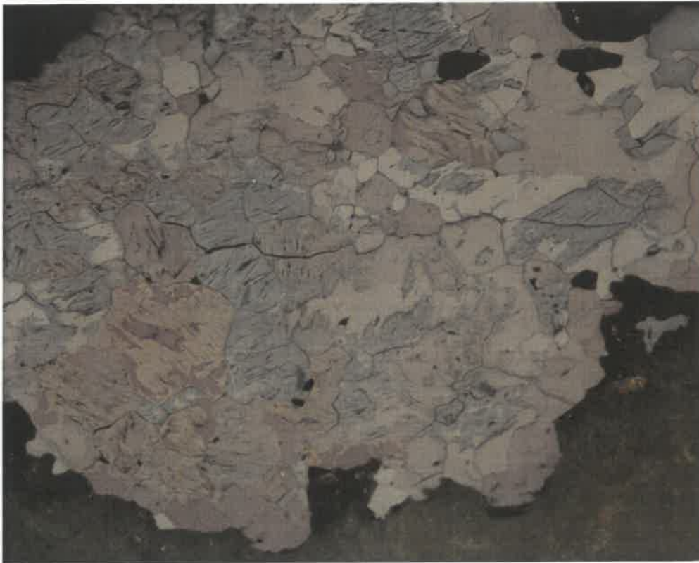
Obr. 34 Zatlačování pyrrhotinu (anizotropní) směsí pyritu (izotropní) a markazitu (anizotropní), stejná oblast jako na obr. 32. Nábrus, XPL, šířka záběru 0.72 mm.
