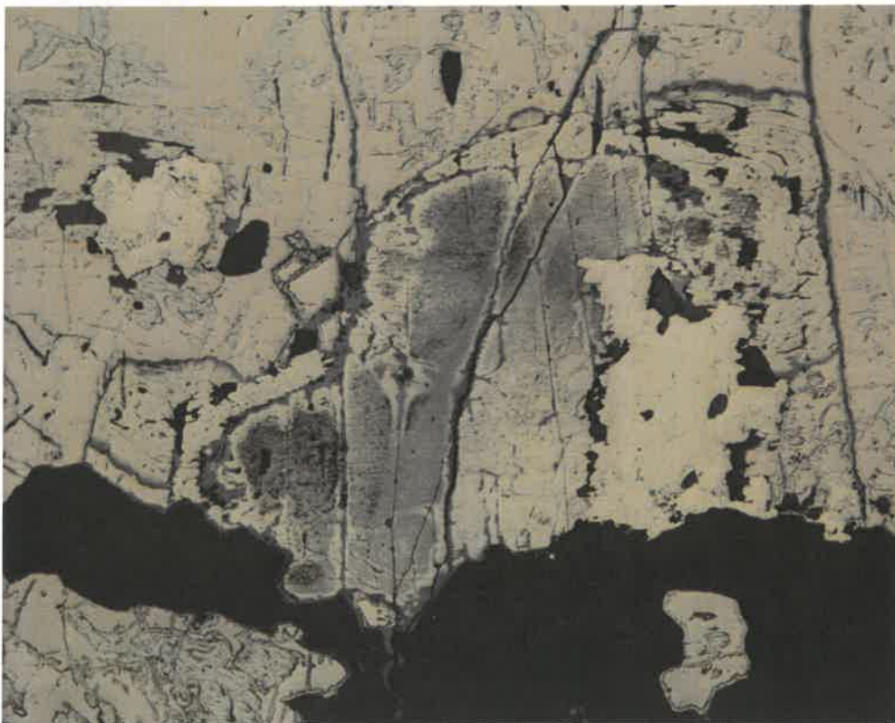
Obr. 32 Zatlačování pyrhotinu (nahnědlý) silně porézním pyritem (střední část snímku) za vzniku textury „ptačích očí“. Nábrus, PPL, šířka záběru 3.6 mm.
