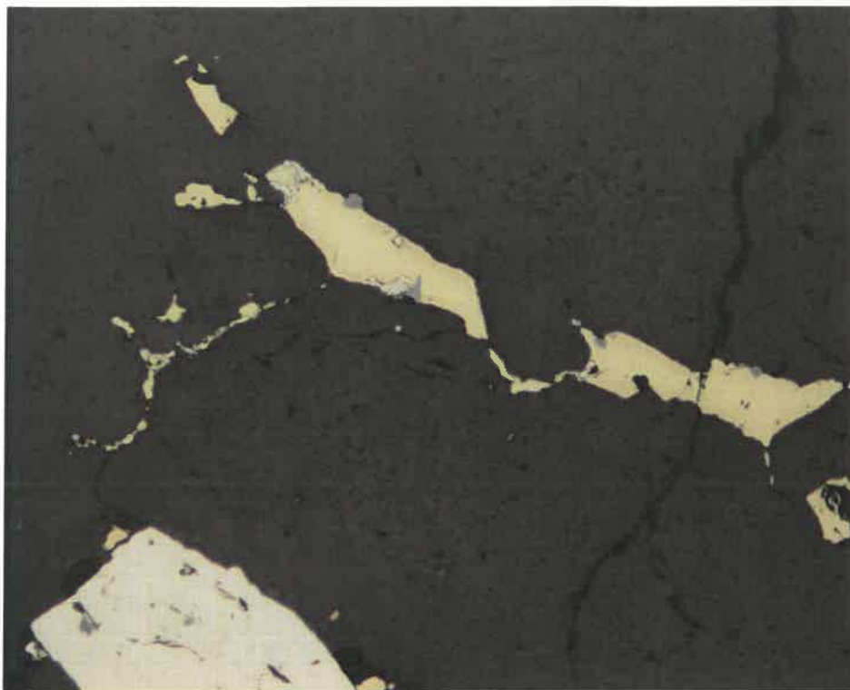
Obr. 1 Automorfni krystaly pyritu (krémový) a mladší proniky chalkopyritu (žlutý) s inkluzemi sfaleritu (světle šedý) v křemeni (tmavošedý). Nábrus, odražené polarizované světlo (PPL), šířka záběru 1.44 mm.
